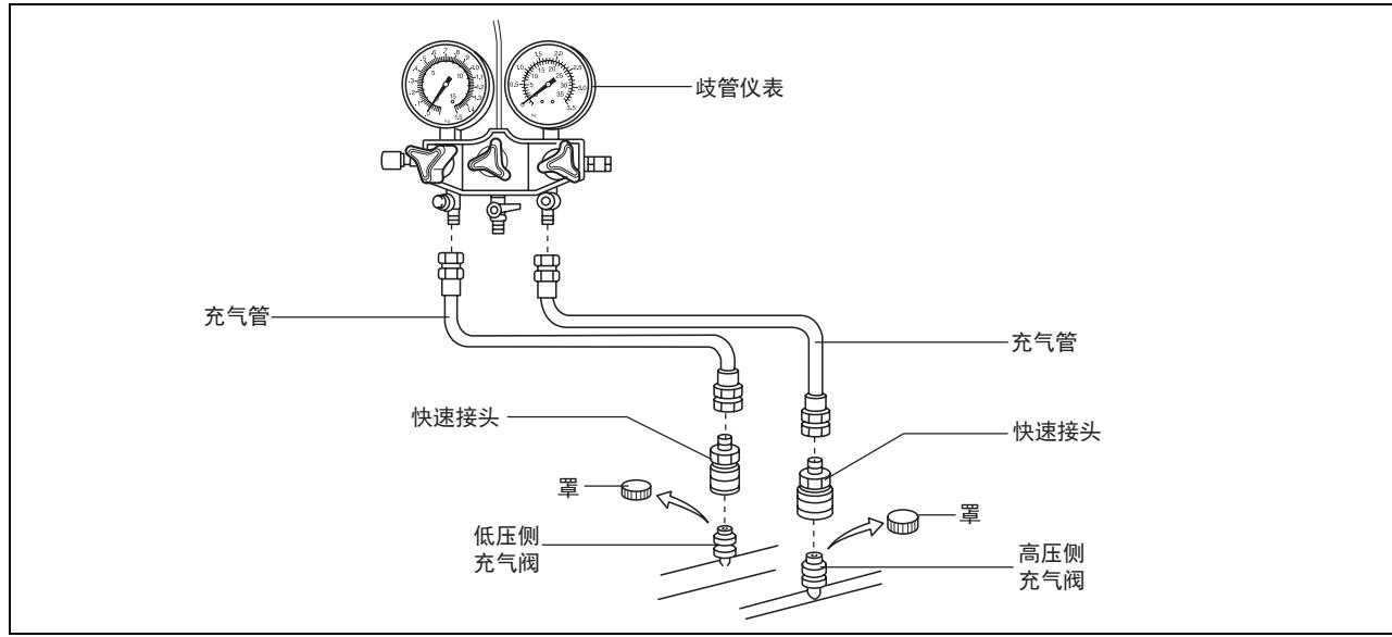
3. 充气软管两端连接快速接头。
